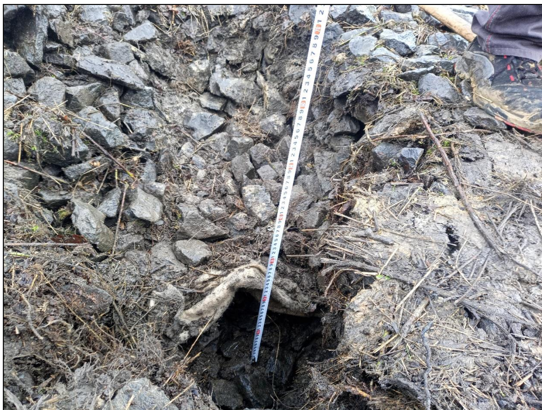
Obr. č. 19 – Kopaná sonda pro ověření stavu odvodňovacího drénu u paty náspu vpravo, km 186,720
