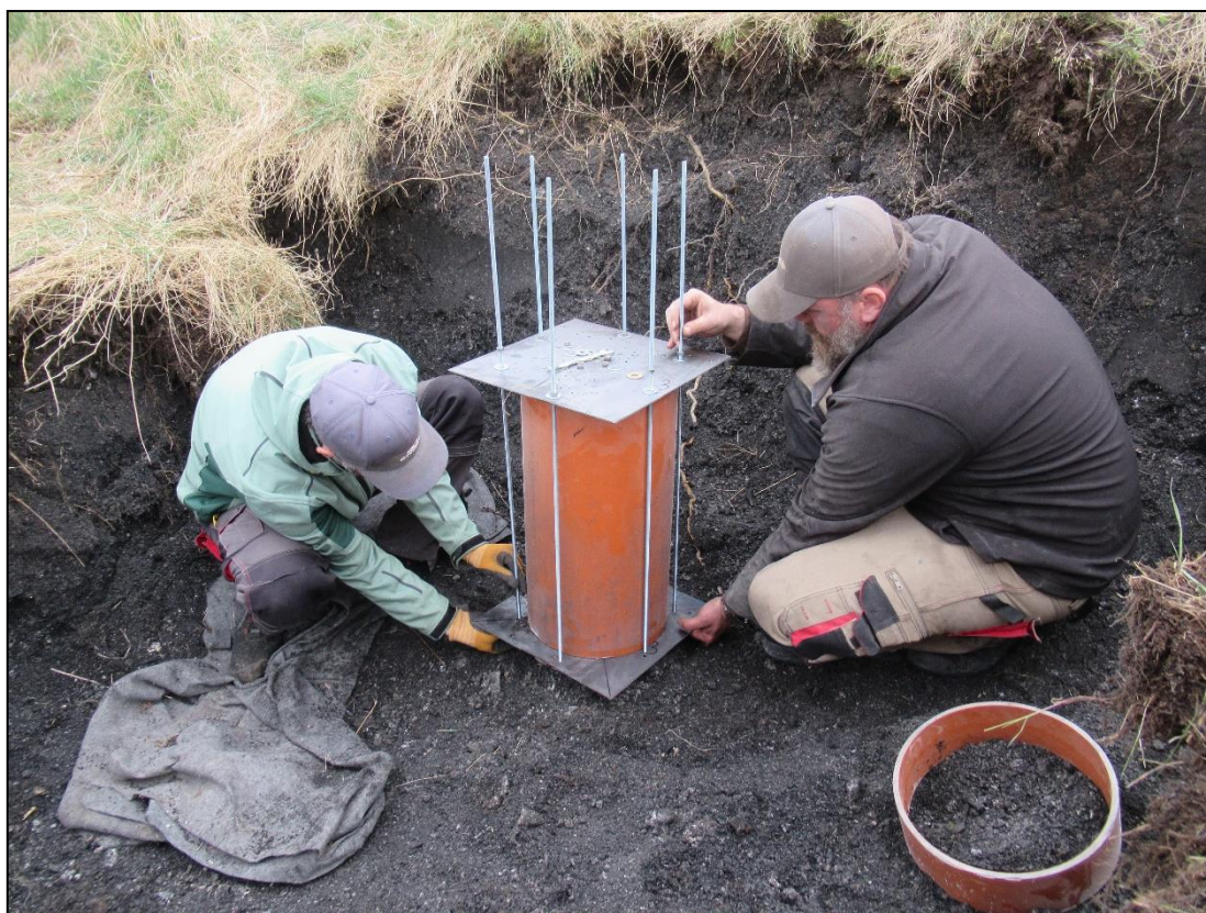
Obr. č. 24 – Odběr velkorozměrových vzorků, deponie v km 186,600 vpravo
